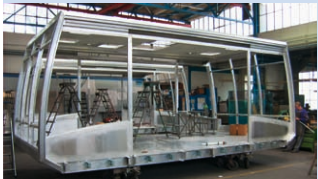
Das Gerüst der neuen Kabinen von Gangloff im Werk Bern.
