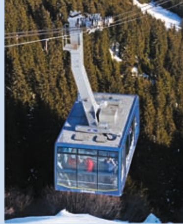
Das fangbremslose Laufwerk gibt der Fahrkonstruktion einen schlanken und eleganten Anblick.
